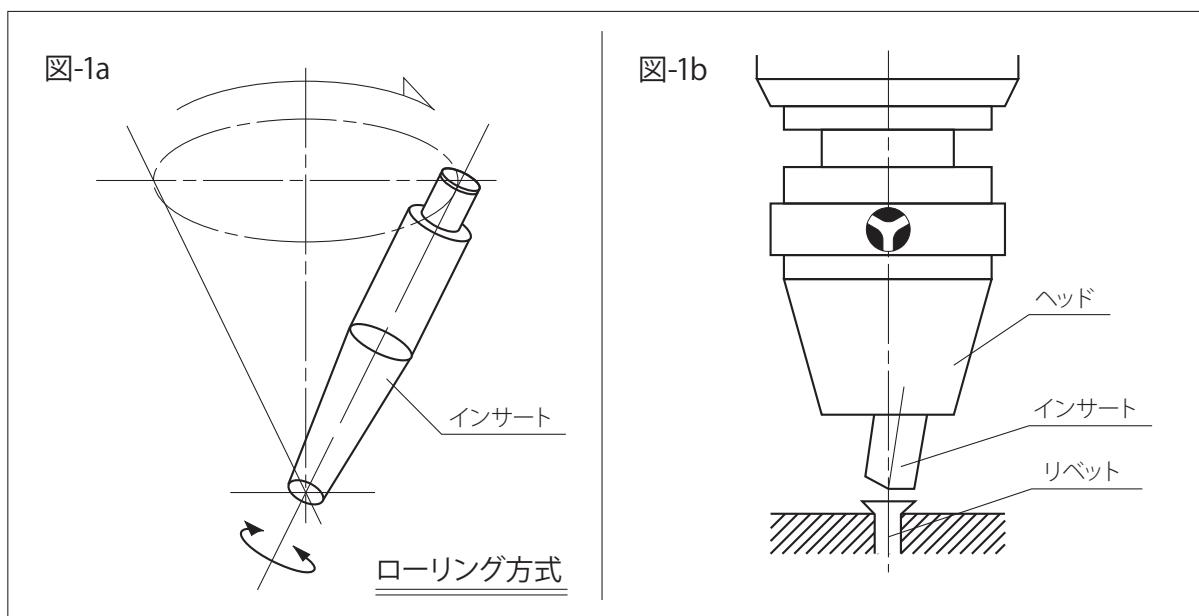
通常インサートはヘッドと一体となって回転していますが、インサートがリベットの先端に接触したときからインサート自身は回転しないで、逆さに立った円錐形の表面を回るような運動を行います。(図-1a参照)
